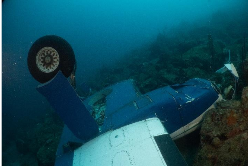
Fig. 4 – Imagen del motor izquierdo acoplado a su fijación de ala izquierda.
