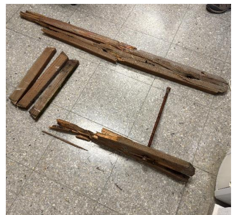
Fig. 6 – Imagen de la escalera restante con daños.
